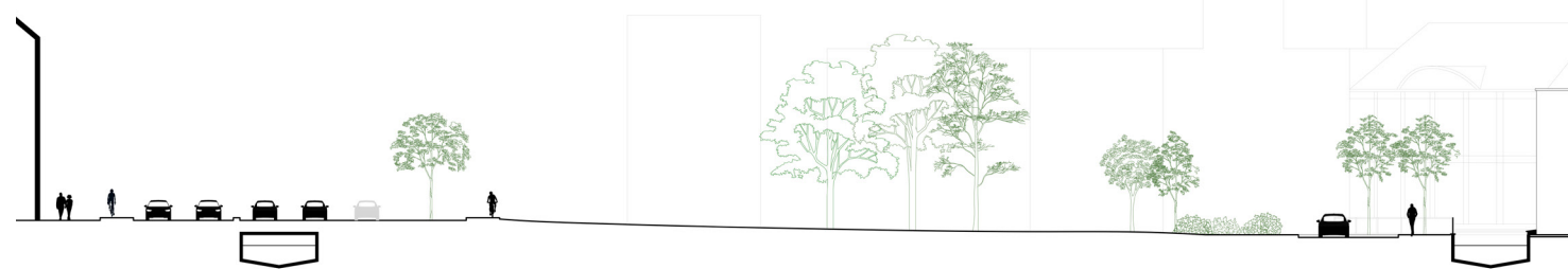
Snede bestaande toestand - waterlopen gebetoneerd
