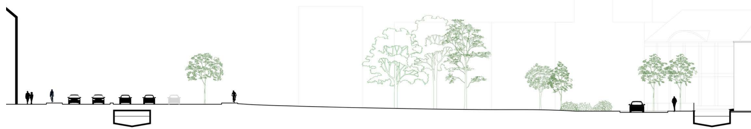
Snede bestaande toestand - waterlopen gebetoneerd
